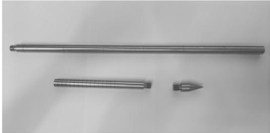
$\phi 7$ 探杆与主机连接时,需要1个对应的转接头。
