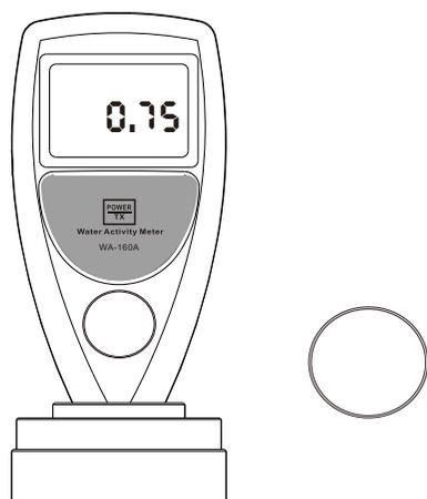
6. 检查测量室有没有吻合，吻合好后测量开始
